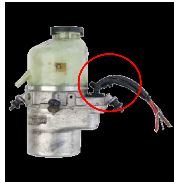
Uszkodzone kable i zakończenia
